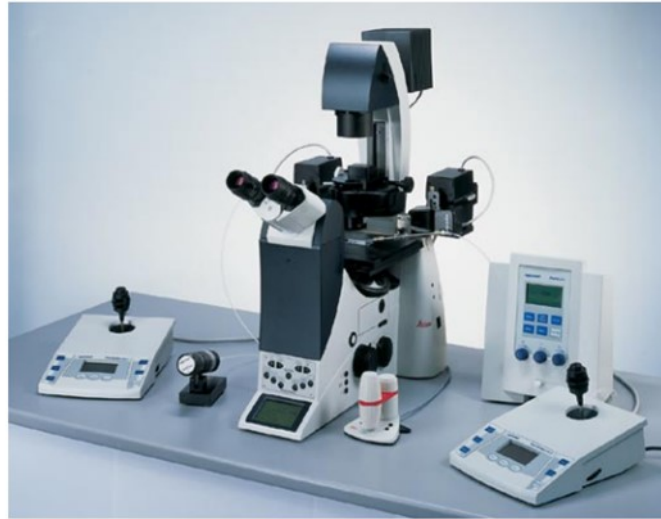
Şekil 2. Mikro-enjeksiyon sistemi; micromanipulator sistemi, inverted mikroskop, femtojet ve cell tram oil/air
